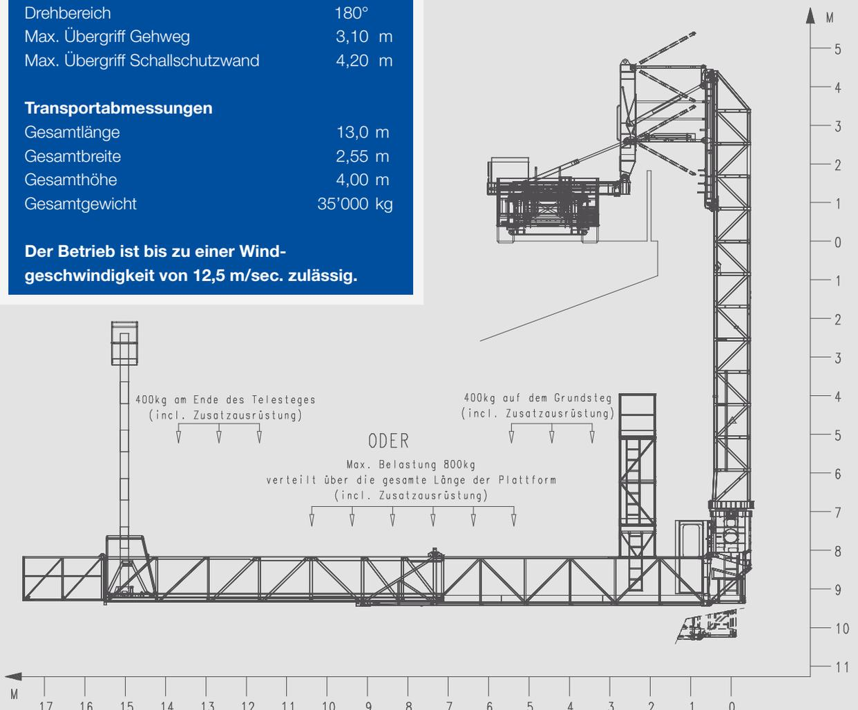
Teleskopdrerahmen ermöglicht einen Gehwegübergriff von 4,2 m
